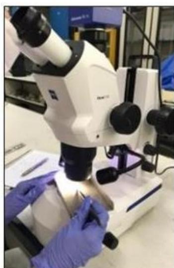
**Figura 26:** Estereoscópio – Stemi 508, utilizado para descrição das amostras de calha.
