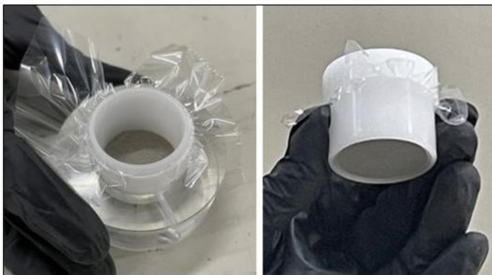
**Figura 30:** Capsulas de plástico utilizados para as análises químicas de FRX. A base do recipiente é o contato entre a amostra e o leitor do equipamento.
