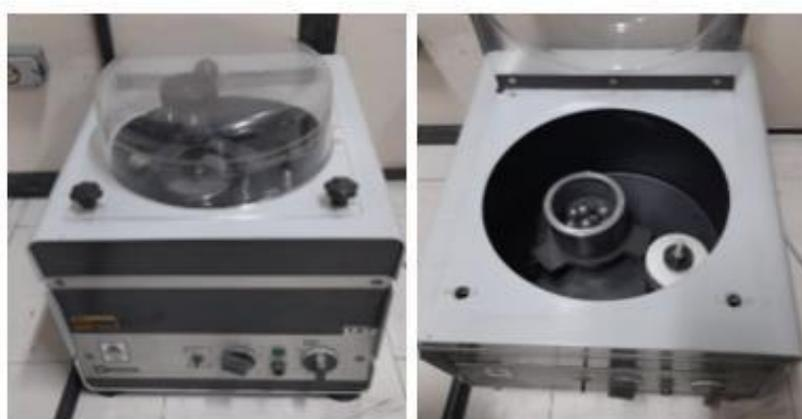
**Figura 32:** Moinho de bolas de carbeto de tungstênio do tipo planetário, modelo S1 da Retsch, usado para moer as amostras para a difração de raios-X.
