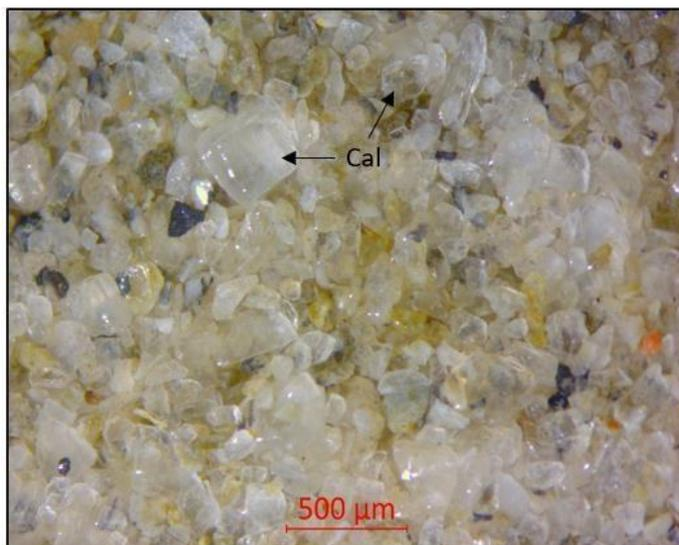
**Figura 50:** Calcita de tampão de combate à perda de circulação encontrada na amostra de calha do poço 1-OGX-101-MA, profundidade 1491 m.
