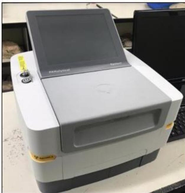
**Figura 31:** Equipamento de fluorescência de Raios-X EPSILON 1 da Malvern Panalytical utilizado para leitura química elementar das amostras de calha.
