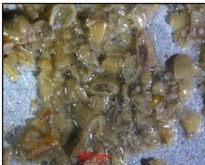
**Figura 51:** Material componente do fluido de perfuração encontrado na amostra de calha do poço 1-OGX-93-MA na profundidade de 1608 m.
