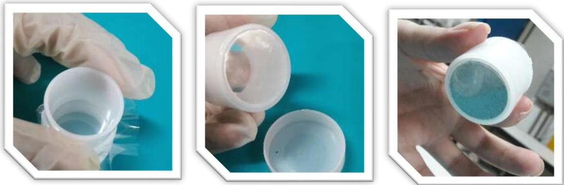
Figura 19 - *Sample cup* com filme de prolene utilizado para as análises no XRF. Fonte: do Autor.
