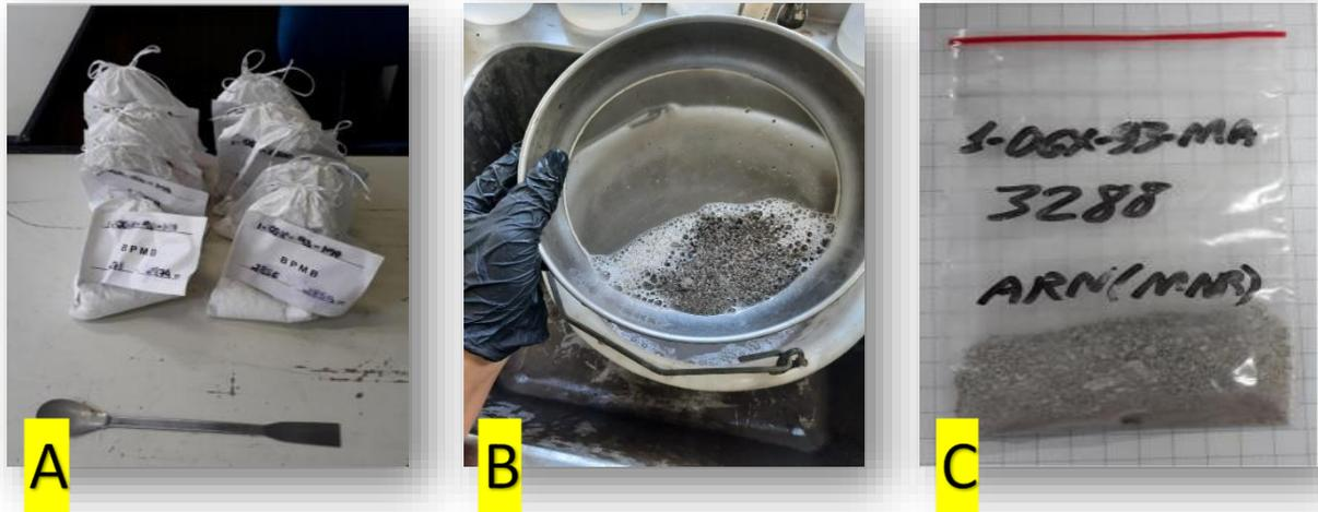
Figura 16 - Processos de amostragem (A), lavagem (B) e armazenamento das amostras de calha em sacos tipo zip lock.
