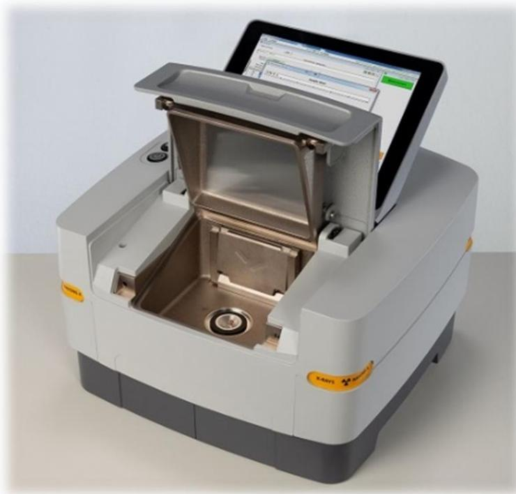
Figura 14 - Foto do equipamento XRF de bancada *Epsilon 1*. Fonte: Malvern Panalytical (2023)
