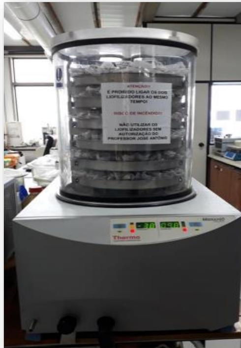
Figura 17 - Etapa de secagem das amostras no liofilizador.
