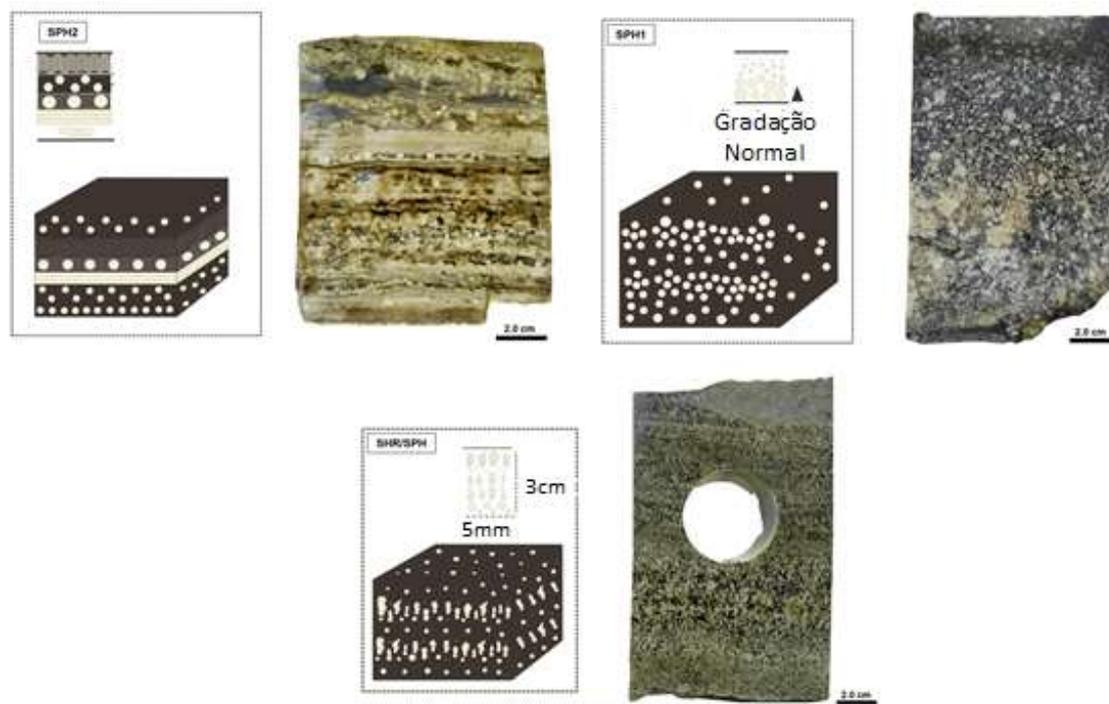
Figura 7: Intervalos do testemunho do poço 2-ANP-1 contendo fácies esferulíticas (Adaptado de Petersohn, 2013).
