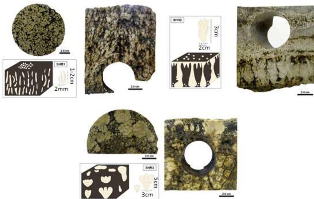
Figura 8: Intervalos do testemunho do poço 2-ANP-1 contendo fácies do tipo *shrubs* (Adaptado de Petersohn, 2013).
