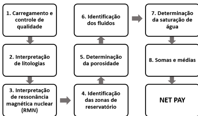
Figura 23: Fluxograma utilizado para a avaliação das formações dos poços do Campo de Búzios.
