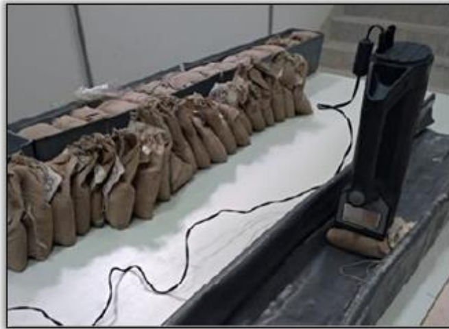
Figura 23: Foto do gamaespectrômetro utilizado nas amostras de calha para a geração das curvas individualizadas de tório, urânio e potássio. Fonte: Nobre (2019).
