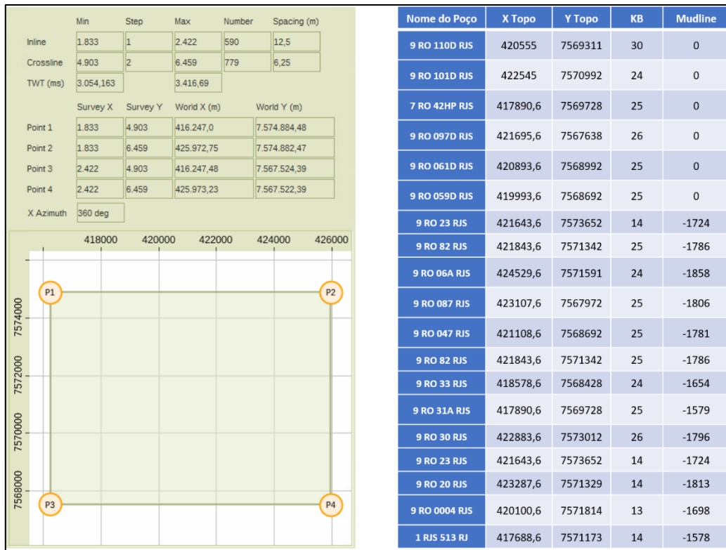
Figura 48: Coordenadas geográficas da survey e dos poços disponíveis com informações adicionais sobre a mesa rotativa (KB) e da mudline (TVDml) em relação ao nível do mar.
